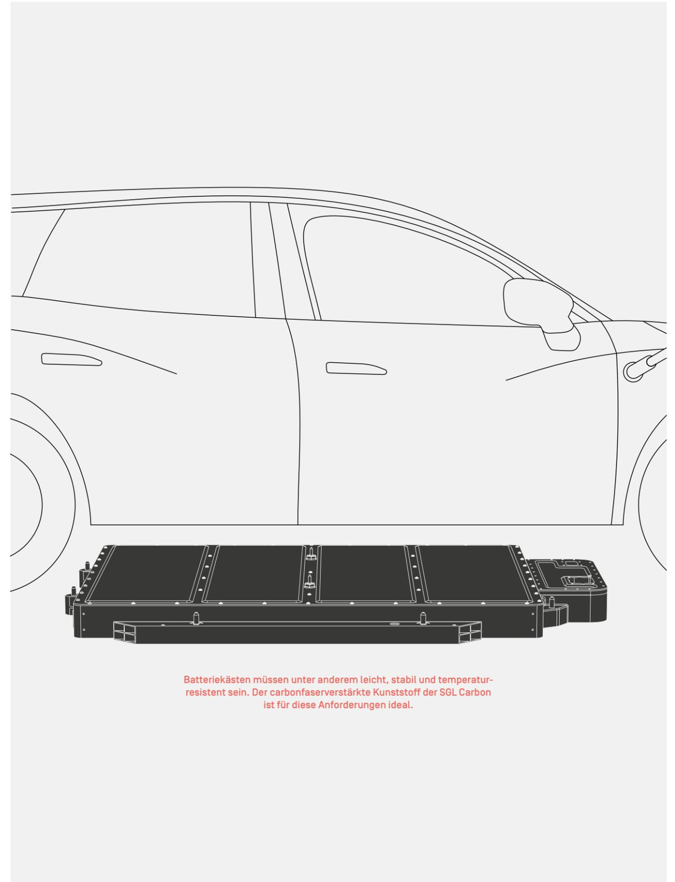
Batteriekästen müssen unter anderem leicht, stabil und temperaturresistent sein. Der carbonfaserverstärkte Kunststoff der SGL Carbon ist für diese Anforderungen ideal.
