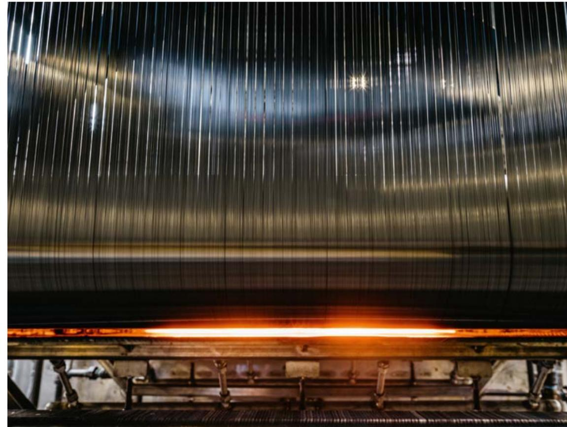
Bei bei mehr als 1.000 Grad Celsius werden die vorbehandelten goldbraunen Fasern carbonisiert. Die schwarzen Bündel bestehen jetzt zu rund 95 Prozent aus Carbon.
